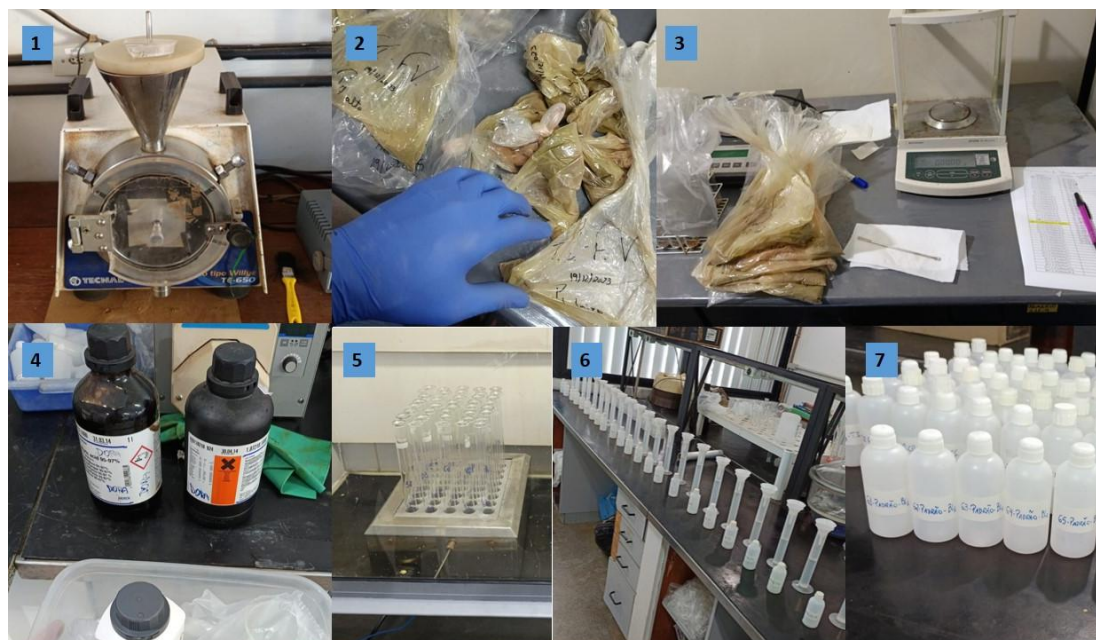
Figura 3 - Etapas para extração e determinação de nutrientes. 1 – moinho de faca tipo Willey; 2 – pó resultante da moagem das amostras compostas; 3 – pesagem do material e acondicionamento em tubos para digestão; 4 – reagentes utilizados no preparo da solução extratora; 5 – bloco digestor com os tubos, material vegetal e solução extratora; 6 – bateria de filtragem da solução resultante da digestão; e, 7 – frascos com o extrato resultante para posterior determinação dos nutrientes.
