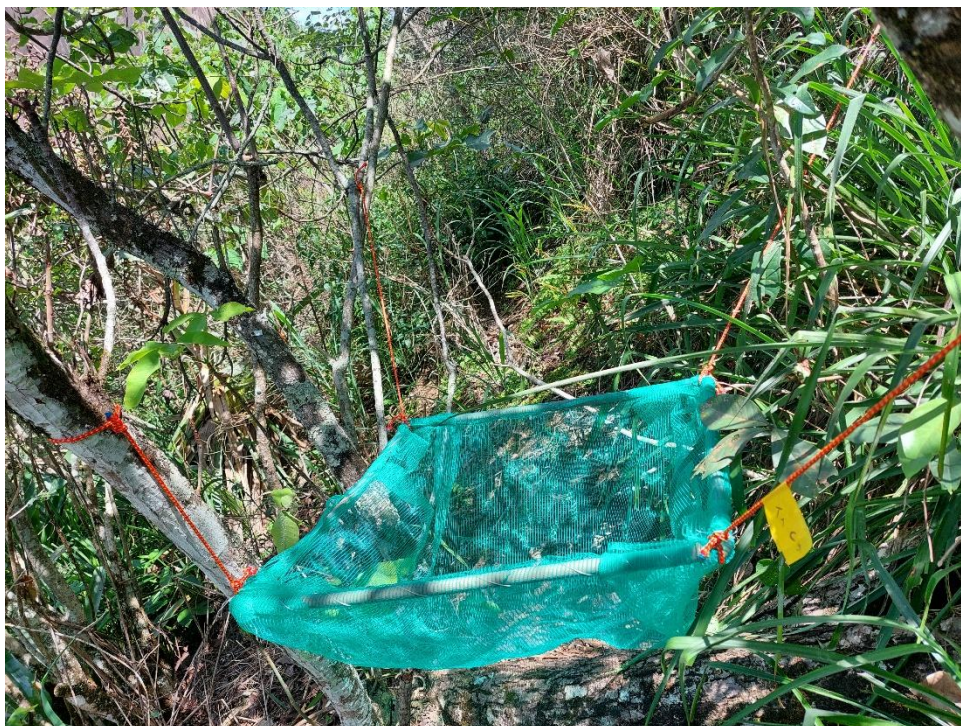
Figura 1 - Coletor de 70x70 cm, revestido com tela de mosquiteiro e alocado a 50 cm do solo, com o auxílio de cordas em meio a vegetação lenhosa de inselbergs. Foto: o autor, Inselberg Santa Angélica.
